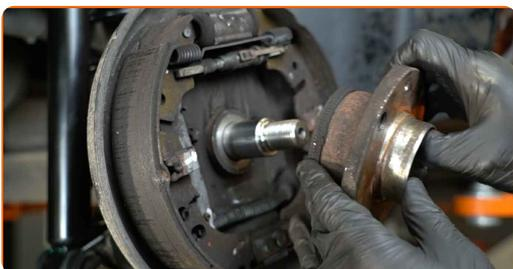
**13** Rengør navlejets monteringsæde. Brug en stålbørste. Brug universal rengøringsmiddel.
