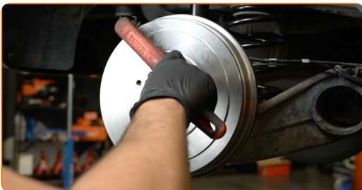
**22** Behandl overfladen hvor hjulremmen berøre bremsetromlen. Brug kobberfedt.
