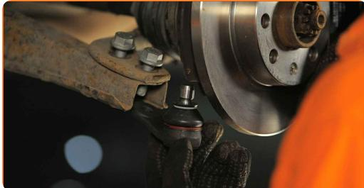
Udskiftning: bærekugle – VAUXHALL Corsa Mk I (B) Hatchback (S93).
