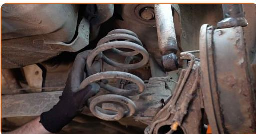
**18** Rengør spiralfjeder beslag sædet. Brug en stålbørste. Brug WD-40 spray.
