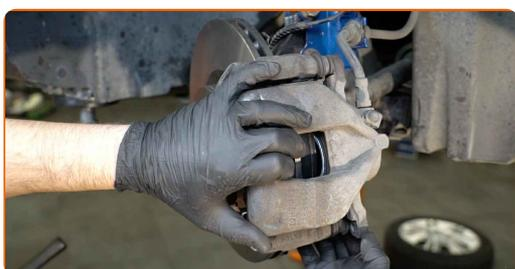
**31** Behandle overfladen hvor bremsekiven har kontaktflade til hjulnavet. Brug kobberfedt.
