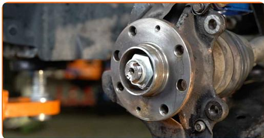
**20** Rengør navet. Brug en stålbørste. Behandl kontaktfladen. Brug kobberfedt.
