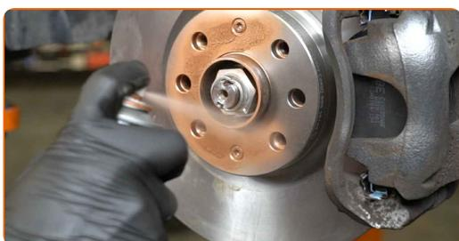
**32** Rengør bremsekivens overflade. Brug bremserens.
