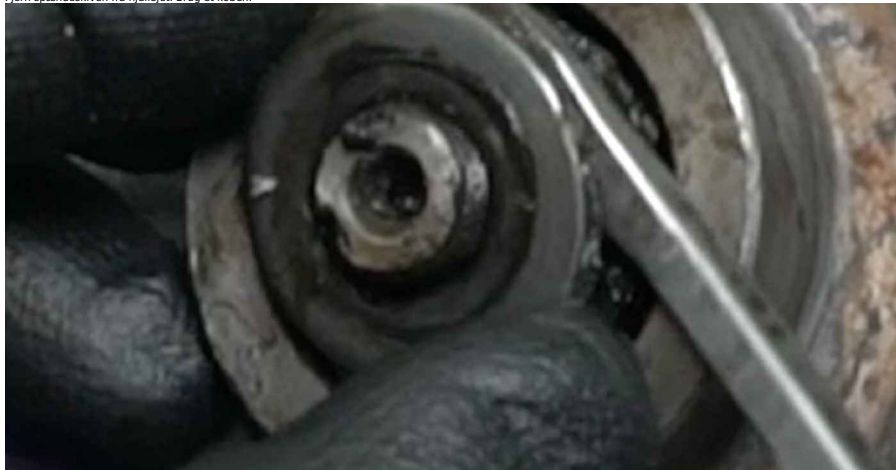
10 Fjern hjulnavlejet. Brug et koben.
