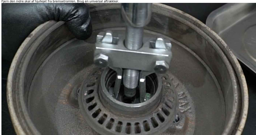
15 Fjern den indre skal af hjullejet fra bremsetromlen. Brug en universal aftrækker.
