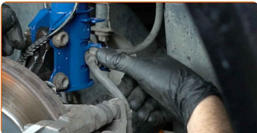
**55** Installer bremseslange holderklipsen. Brug en gummihammer.
