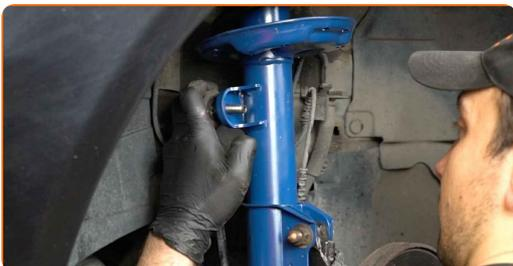
**58** Spænd befæstigelsen til der forbinder forbindelsesstangen med fjederbenet. Brug en kombinøgle № 15. Brug Torx T30. Brug en momentnøgle. Stram den til 40 Nm moment.
