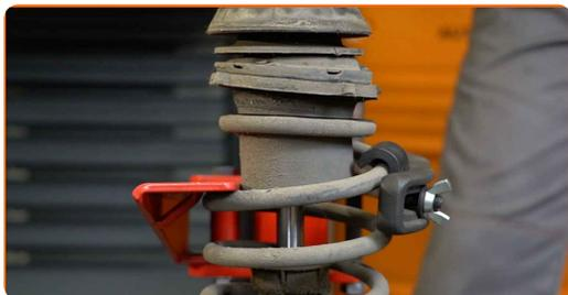
**35** Behandel fjederbenets stang. Brug en stålbørste. Brug WD-40 spray.
