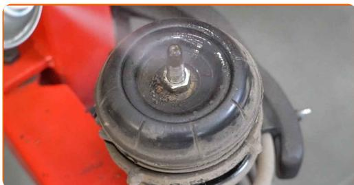
**36** Fjern møtrikken på stiverens stempelstang. Brug en støæmper modhold topnøgle N°DD9. Brug en kombinøgle N° 18. Brug en skraldenøgle.
