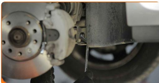
13 Tag kugleledet af styrekuglen. Brug en lejeaftrækker.
