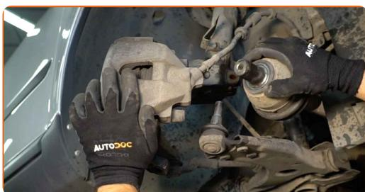
**24** Støt styrekuglen. Brug en hydraulisk løfteenhed.
