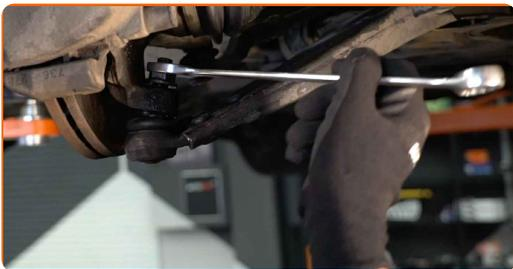
**55** Skru fastgørelsen ind som forbinder fjederbenet med styrekuglen. Brug en kombinøgle N° 18. Brug en topnøgle N°21. Brug en skraldenøgle. Brug en vridenøgle.
