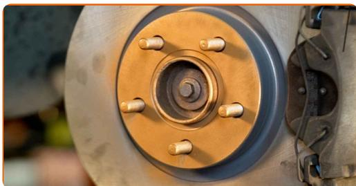
**64** Rengør bremseskivens overflade. Brug bremsrens.
