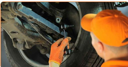
**9** Spænd befæstigelsen til der forbinder forbindelsesstangen med krængningsstabilisatoren. Brug en kombinøgle N° 18. Brug Torx T40. Brug en momentnøgle. Stram den til 50 Nm moment.
