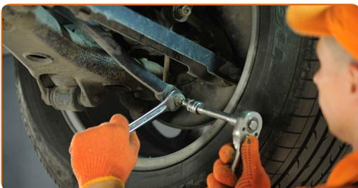
**4** Skru befæstigelsen ud der forbinder stabilisatorstangen med bæreamen. Brug en kombinøgle N° 18. Brug Torx T40. Brug en skraldenøgle.
