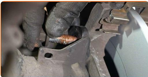
**45** Stram fastgørelserne til bremsekaliberens beslag. Brug en topnøgle N°15. Brug en momentnøgle. Stram den til 110 Nm moment.
