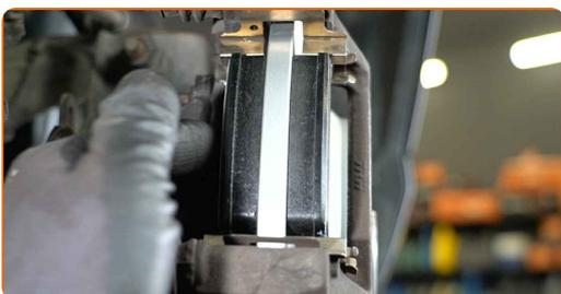
**47** Installer bremsekaliberen og stram til.
