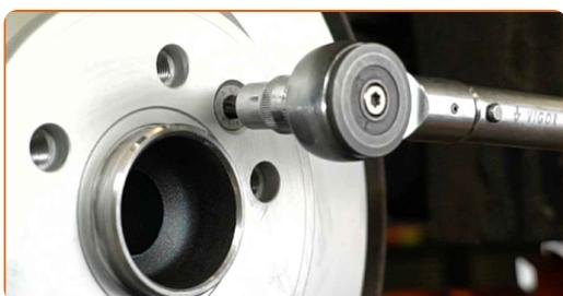
**42** Regør bremsekaliber beslaget for snavs og støv. Brug en stålbørste. Brug bremserens.
