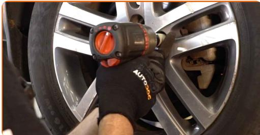
Udskiftning: bremsekaliber – VW Beetle Hatchback (5C1, 5C2). AUTODOC
