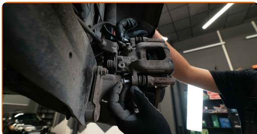
**Udskiftning: bremseklodser – VW Beetle Hatchback (5C1, 5C2). Råd fra AUTODOC eksperter:**
