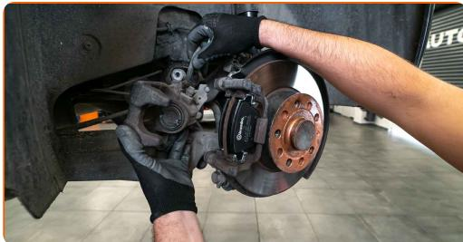
Udskiftning: bremseklodser – VW Beetle Hatchback (5C1, 5C2). Fagfolk anbefaler:
