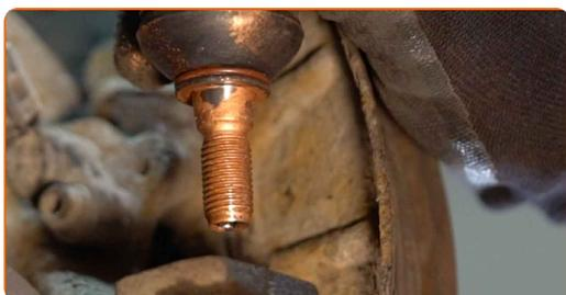
**15** Forbind forbindelsesstangen til styrekuglen.
