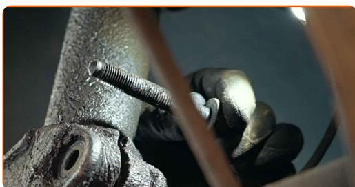
**27** Frigør den nedre befæstigelse der forbinder fjederbenet til stubakslen. Brug en flad metalmejsel. Brug en hammer.
