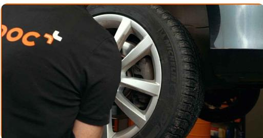
**13** Rens alle samlinger af krængningsstabilisatoren. Rengør befæstigelserne der forbinder fjederben til stubakslen. Brug en stålbørste. Brug WD-40 spray.
