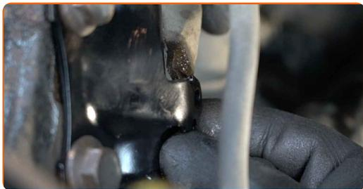
**41** Stram skruerne til bremseslangens beslag på stiveren. Brug en topnøgle N°10. Brug en momentnøgle. Stram den til 13 Nm moment.
