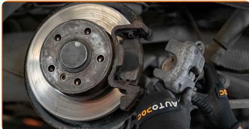
Udskiftning: bremsekaliber – VW Caddy III Van (2KA, 2KH, 2CA, 2CH). Fagfolk anbefaler:
