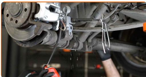
Udskiftning: bremsekaliber – VW Caddy III Van (2KA, 2KH, 2CA, 2CH).
