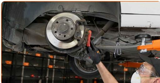
Udskiftning: bremsekaliber – VW Caddy III Van (2KA, 2KH, 2CA, 2CH). Råd:
