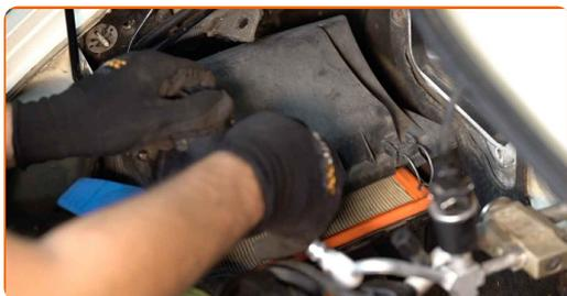
**11** Fjern filterelementet fra filterhuset.
