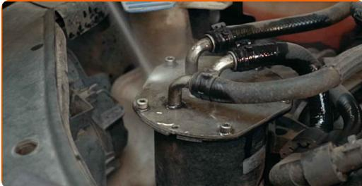
**4** Skru befæstigelse af til brændstoffilterhusets dæksel. Brug Torx T15. Brug en skraldenøgle.
