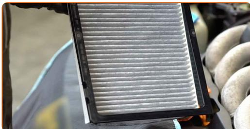
**8** Indsæt et nyt filterelement i filterhuset. Vær sikker på at filterkanterne passer tæt til huset.
