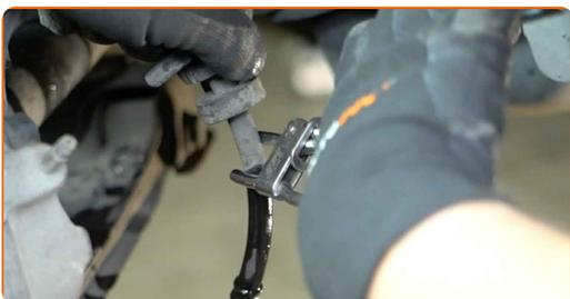
**16** Skru bremseslangen af bremsekalibren.
