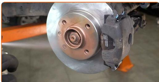
**32** Rengør bremseskivens overflade. Brug bremsrens.
