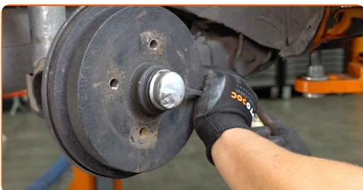
**8** Fjern splitstiften som sikre navmøtrikken. Brug et koben. Brug en skruetrækker med lige kær.
