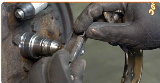
**18** Tag håndbremsekablet af. Brug et koben.
