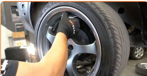
**7** Fjern hjulnav møtrikkens kapsel. Brug et koben. Brug en hammer.
