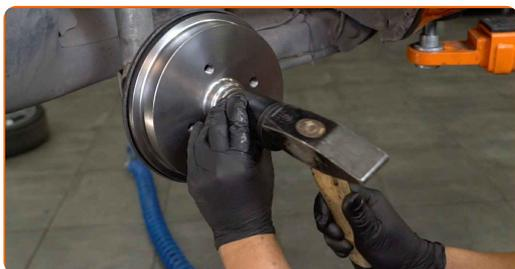
**32** Behandel overfladen hvor hjulremmen berøre bremsetromlen. Brug kobberfedt.
