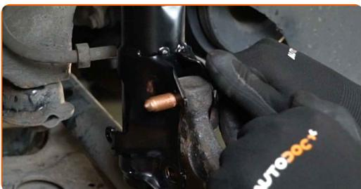
**43** Skru befæstigelse ind der forbinder fjederbenet med styrespindlen. Brug en kombinøgle N° 18. Brug en topnøgle N°18. Brug en vridenøgle.
