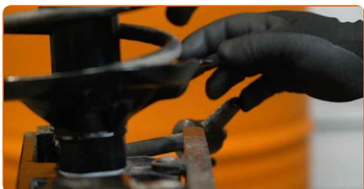
**37** Rengør montagestedet til fjederbenet. Brug en stålbørste. Brug WD-40 spray.
