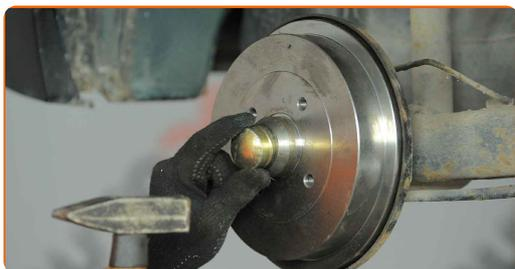
**29** Rens hjulets montagesæde. Brug en stålborste. Behandl overfladen hvor hjulremmen berøre bremsetromlen. Brug kobberfedt.
