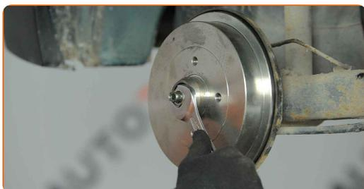
**27** Monter splitten til navlejets møtrik. Brug en hammer. Brug tænger.
