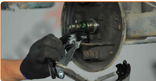
**22** Fastgør bremseskoene sammen med bremsejusterings mekanismen til hjulcyllinderen.
