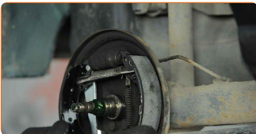
**23** Installer bremseklodsernes låseclips. Brug tænger.
