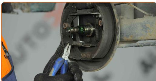
**12** Fjern bremseklodsernes låseclips. Brug tænger.
