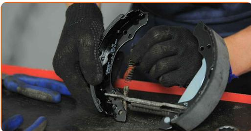
**21** Sæt håndbremsekablet på håndbremsestangen. Brug tænger. Brug tænger.
