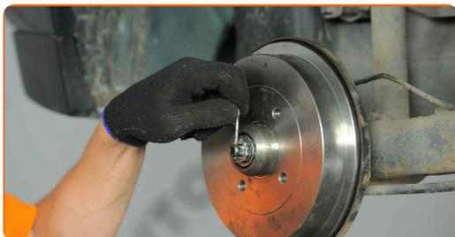
**28** Monter hjullejets beskyttelseshætte. Brug en gummihammer.
