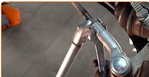
**18** Skru befæstigelses møtrikken ind som forbinder styrekuglen med styrespindel. Brug en topnøgle N°17. Brug en skraldenøgle.
