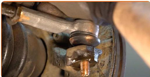
**16** Når du afmonterer, skal du markere eller måle den eksakte position for kugleledet på sporingstangen, eller tælle antallet af omgange du drejer, for at forhindre en efterfølgende dårlig sporing. Brug en skydelære.
