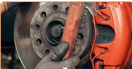
**16** Behandle overfladen hvor bremseskiven har kontaktflade til hjulnavet. Brug keramisk fedt.
