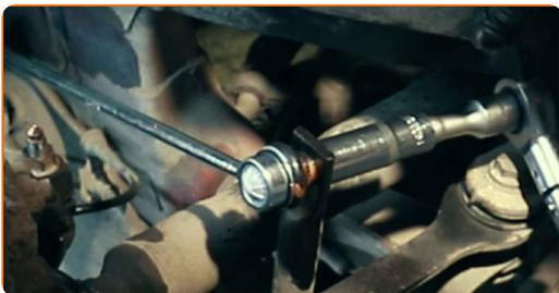
**14** Behandle alle samlinger af krængningsstabilisatoren. Brug kobberfedt.
