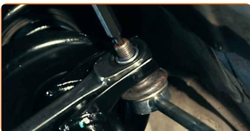
**12** Spænd befæstigelsen til der forbinder forbindelsesstangen med fjederbenet. Brug en topnøgle N°19. Brug en momentnøgle. Stram den til 65 Nm moment.
