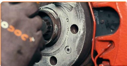
**17** Rengør bremseskivens overflade. Brug bremsrens.
