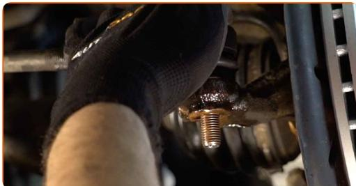
**15** Skru befæstigelses møtrikken ind som forbinder styrekuglen med styrespindel. Brug en topnøgle №18. Brug en skraldenøgle.
