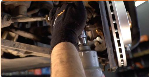
**16** Stram møtrikken der forbinder forbindelsesstangen og styrespindlen. Brug en topnøgle №18. Brug en momentnøgle. Stram den til 20 Nm moment.+90°
