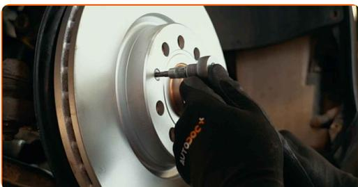
**25** Rens bremsekaliberens beslag for skidt og støv. Brug en stålbørste. Brug bremserens.
