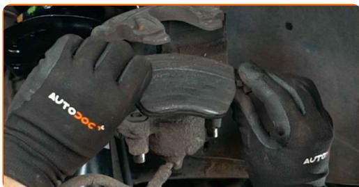
**16** Rengør bremsekaliberen befæstigelse. Brug en stålbørste. Brug WD-40 spray.
