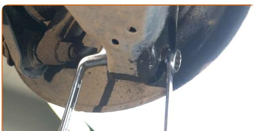
11 Støt armen. Brug en hydraulisk løfteenhed.
