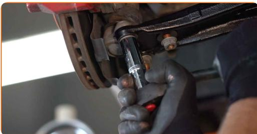
**18** Skru den bageste befæstivelse fast der forbinder bæreammen med underrammen. Brug en topnøgle №15. Brug en topnøgle №18. Brug en skraldenøgle.
