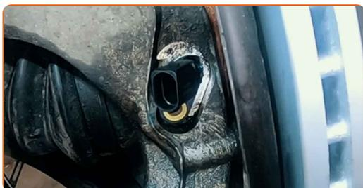
**13** Stram befæstigelse som forbinder ABS sensoren med styrespindlen. Brug HEX nr. H5. Brug en momentnøgle. Stram den til 7 Nm moment.
