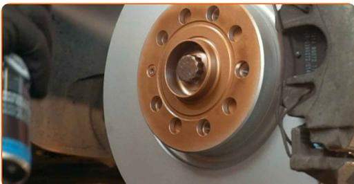
**18** Rengør bremseskivens overflade. Brug bremsrens.
