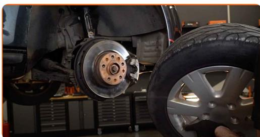
6 Rengør befæstigelsen der forbinder forbindelsesstangen og styrespindel. Brug en stålborste. Brug WD-40 spray.
