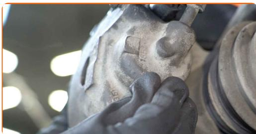
**20** Behandle overfladen hvor bremseklodsen har kontaktflade til hjulnavet. Brug kobberfedt.
