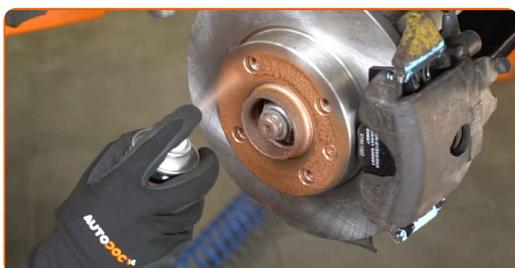
**21** Rengør bremseklodsens overflade. Brug bremserens.
