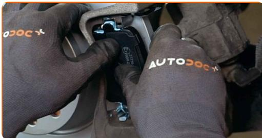
**Udskiftning: bremseklodser – VW Jetta Mk5 (1K). Råd fra AUTODOC eksperter:**
