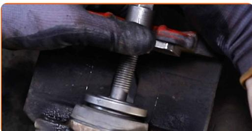
**32** Montér bremsekaliberens styrepinde.
