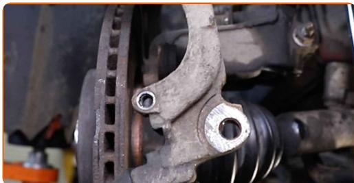
**17** Rengør bremseskivebefæstigelsen. Brug en stålbørste. Brug WD-40 spray.
