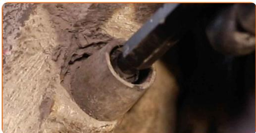
**11** Fjern bremsekaliberen.
