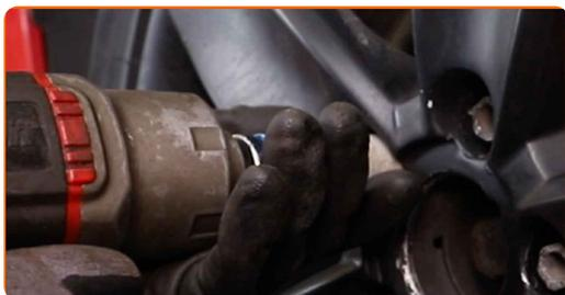
**43** Sænk bilen og stram hjulboltene på kryds med. Brug hjul slagnøgle #17. Brug en momentnøgle. Stram den til 120 Nm moment.
