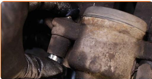
**33** Behandel bremseklodserne på kontakfladerne hvor de kommer i kontakt med bremsekaliber åget. Brug anti-hvin smøremiddel.
