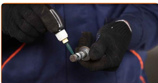
**29** Installer bremsekaliberens beslag.
