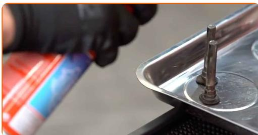
**26** Behandel bremsekaliber styrestifterne. Brug bremsekaliber fedt.
