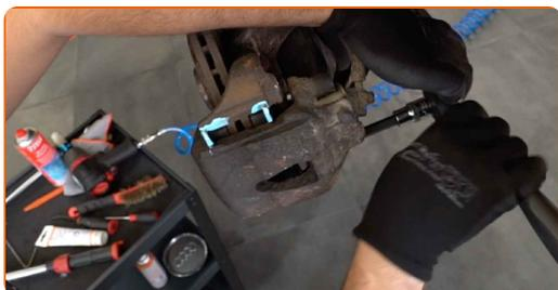
**11** Fjern bremsekaliberen.
