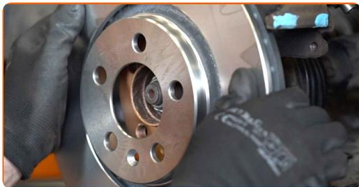
**16** Stram bremseskivens skruer. Brug Torx T30. Brug en momentnøgle. Stram den til 4 Nm moment.
