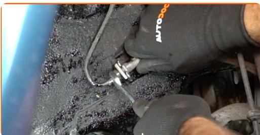
**14** Fjern bremseslang holderklipsen. Brug et koben.
