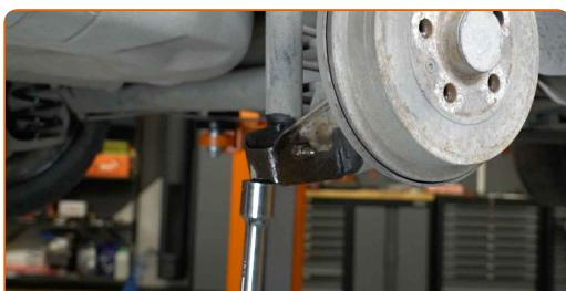
8 Skru de nedre skruer af støddæmperen. Brug en kombinøgle № 16. Brug en topnøgle №16. Brug en skraldenøgle.
