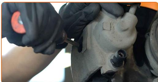
**11** Fjern bremsekaliberen.
