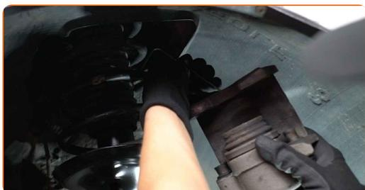
Udskiftning: bremseklodser – VW Passat B1 Variant (33). Fagfolk anbefaler:
