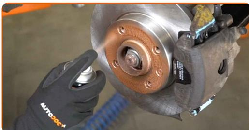
**21** Rengør bremseklodsens overflade. Brug bremserens.
