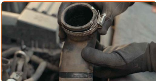
10 Tildæk luftindsugningsslangen med et mikrofiber håndklæde for at undgå at støv og skidt kommer ind i systemet.
