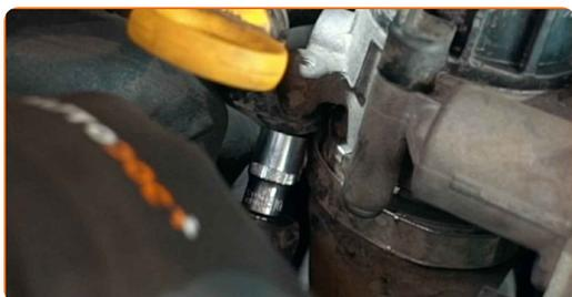
8 Løsen befæstigelsen af luftindsugningsslangen. Brug en topnøgle №7. Brug en skraldenøgle.
