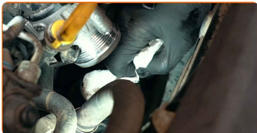
58 Rengør montagestedet til luftindsugningslangen. Brug universal rengøringsmiddel.
