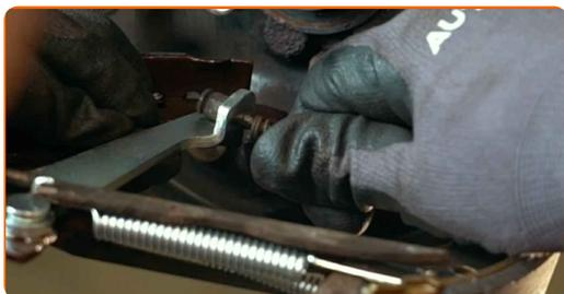
**25** Installer bremseskoene på den virkende bremsecylinder på beslaget og på bremsestøttepladens beslag.
