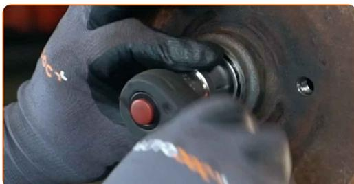
**12** Fjern bremsetromle samling med hjulnavlejet.
