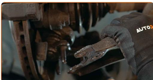
24 Støt styrekuglen. Brug en hydraulisk løfteenhed.
