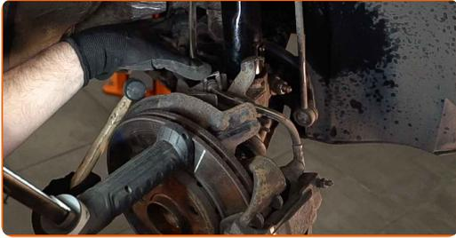
**52** Rens hjulets montagesæde. Brug en stålbørste. Behandl kontaktfladen. Brug kobberfedt.
