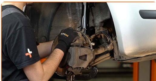
**41** Støt styrekuglen. Brug en hydraulisk løfteenhed.
