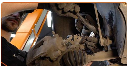
**17** Rengør kugleleddets montagesæde. Brug en stålbørste. Brug WD-40 spray.
