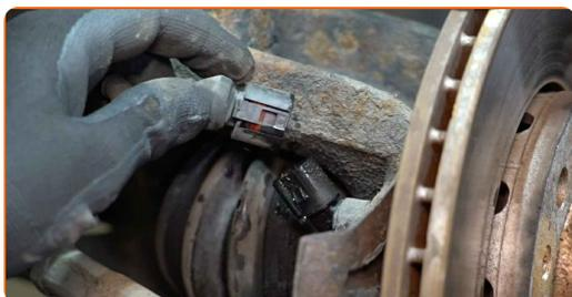
**8** Rengør ABS sensorens befæstigelse. Brug en stålbørste. Brug WD-40 spray.
