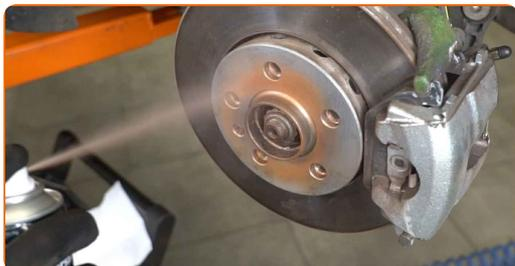
**31** Rengør bremsekivens overflade. Brug bremserens.
