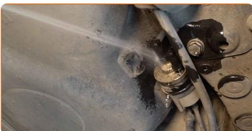
**6** Afbryd brændstofforsyningens slanger fra brændstoffilteret. Brug et koben.
