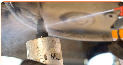
**9** Afbryd brændstofforsyningens slanger fra brændstoffilteret. Brug et koben.
