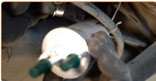
**13** Spænd brændstoffilterets skruer. Brug en Phillips skruetrækker.
