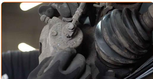
24 Behandle overfladen hvor bremsestiven har kontaktflade til hjulnavet. Brug kobberfedt.
