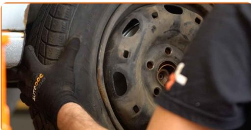
Udskiftning: bremsekiver – VW Polo V Hatchback (6R1, 6C1). Råd fra AUTODOC eksperter:
