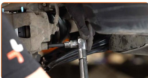
23 Monter støvhætter på bremsekaliberens styretapper.
