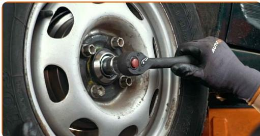
Udskiftning: bremsetromler – VW Polo Variant (6V5). Råd fra AUTODOC eksperter:
