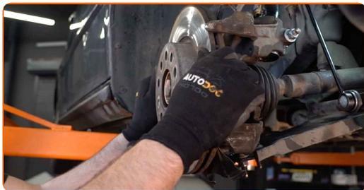
**32** Stram bremseskivens skruer. Brug Torx T30. Brug en momentnøgle. Stram den til 4 Nm moment.
