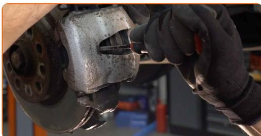
**10** Fjern bremsekaliberen.
