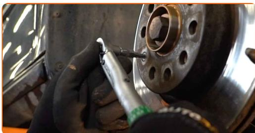
**33** Monter bremsekaliberen og sæt den fast. Brug HEX nr. H7. Brug en momentnøgle. Stram den til 30 Nm moment.
