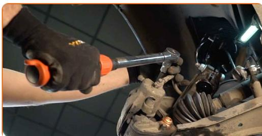
**34** Monter støvhætter på bremsekaliberens styretapper.
