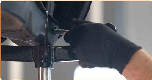
13 Sænk den hydrauliske donkraft med 10 til 15 cm.
